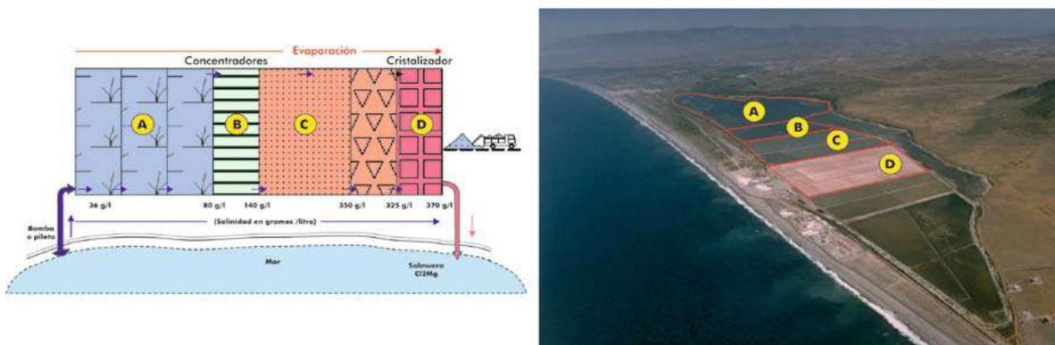
Figura 3. Esquema del proceso salinero. En la imagen aérea se identifican las áreas de las salinas referidas en el esquema.
