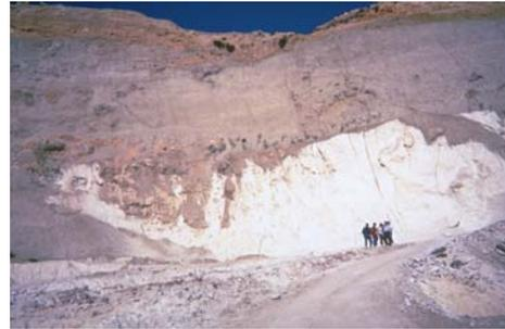
*Las masas mineralizadas suelen estar recubiertas por roca no mineralizada que es necesario retirar para la explotación.*
