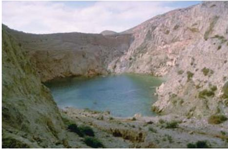
Cantera de bentonitas explotada de modo intermitente en la Serrata de Níjar. Las masas bentoníticas que presentan una cierta coloración tienen menos interés comercial que las blancas.
