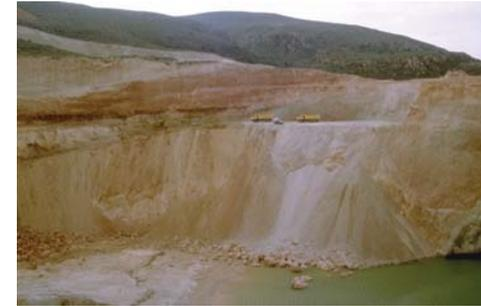
*La Cantera de los Trancos es la principal explotación de bentonitas del Parque. Puede observarse la envergadura de los bancos de explotación tomando como escala los camiones.*
